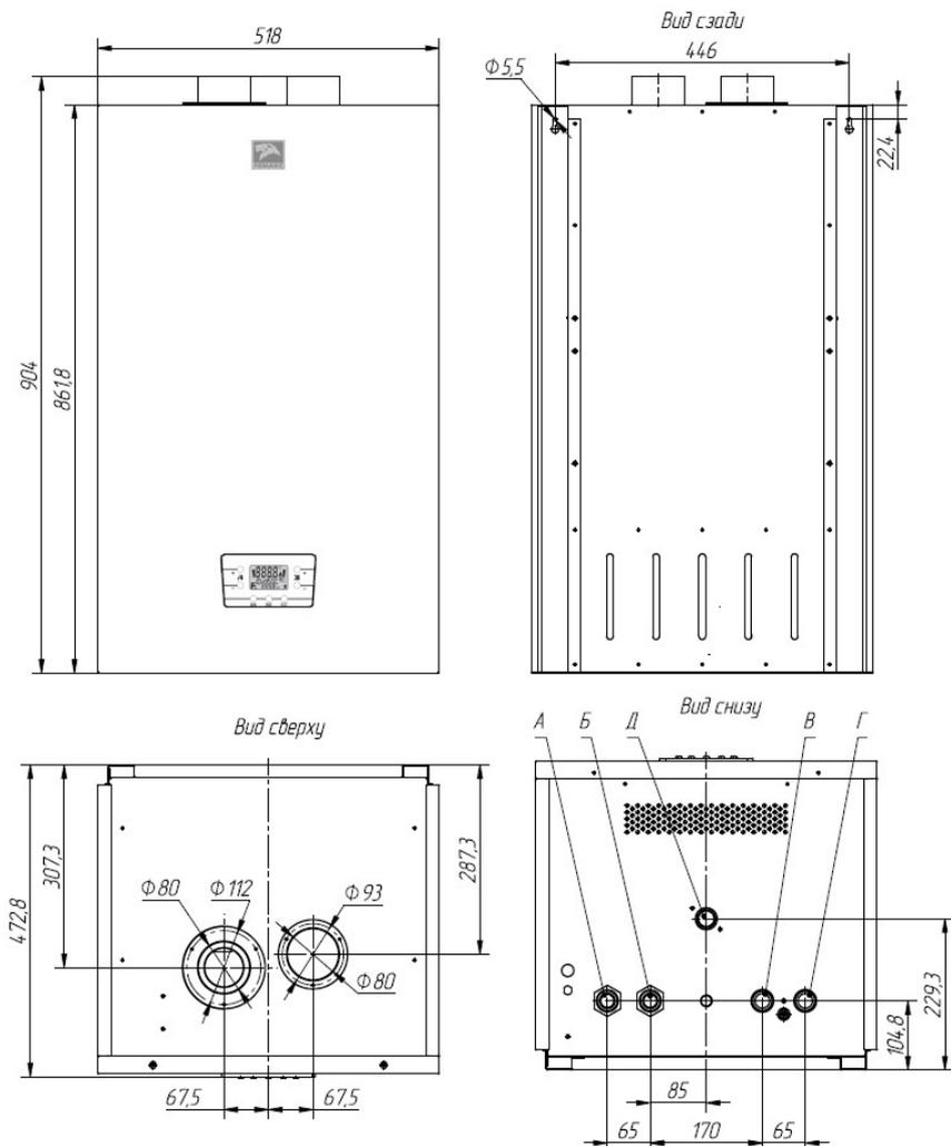
Рис. 2.1. Габаритные и присоединительные размеры котла Prime-V55 HO
