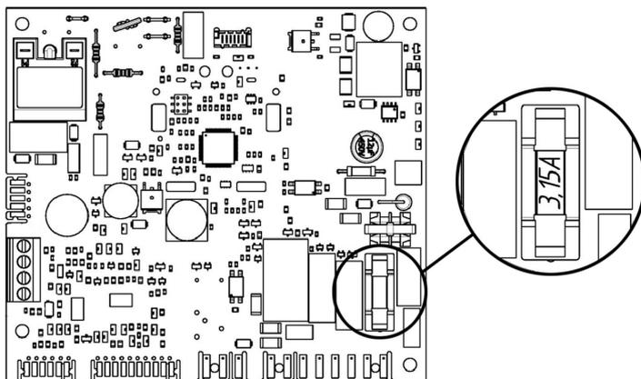
**Рис. 13. Расположение предохранителя**
