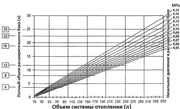
**Пример:** по расчёту система требует установки расширительного бака ёмкостью 13 литров, котёл оборудован расширительным баком 6 л, т.е.  $13 - 6 = 7$  л. Следовательно, необходимо установить дополнительно бак объёмом 7 л. По номограмме выбираем ближайший больший стандартный расширительный бак объёмом 8 литров.
