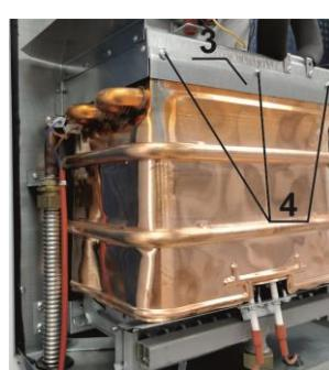
Рис. 19. Демонтаж труб и теплообменника
