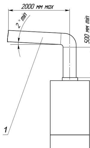
Рис. 11. Схема подсоединения дымоотводящей трубы для котла «VilTerm 24»
