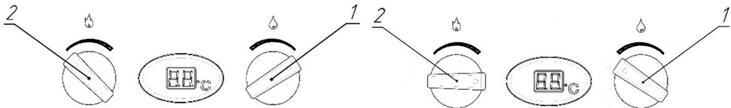
а) Ручки регулировки расхода воды 1 и расхода газа 2 положении “**Минимальный расход**”
